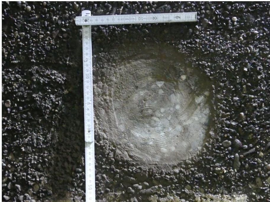
Bild 8 Schleifprobe mit Freilegung Korngerüst
